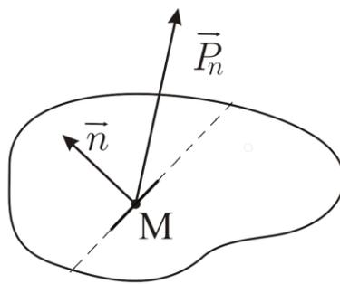
В данной точке среды можно и даже нужно рассматривать всевозможные площадки (с разными нормальями). Вектор напряжений на разных таких площадках – разный. Ориентация площадки определяется вектором  $\vec{n}$ : площадка перпендикулярна вектору  $\vec{n}$ , причем вектор  $\vec{n}$  направлен в ту сторону, откуда действует сила на данную площадку.
