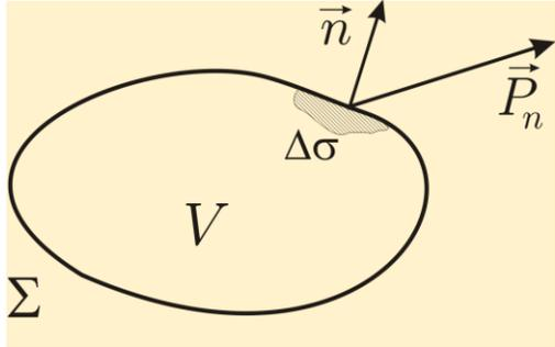
$\Sigma$  - поверхность объема  $V$ ;  $\Delta\sigma$  малый элемент поверхности;  $\vec{n}$  - нормаль к  $\Delta\sigma$ , направленная во внешнюю сторону, то есть в ту сторону, откуда действует внешняя сила,  $\vec{P}_n$  - вектор напряжений (иногда обозначается  $\vec{P}^{(n)}$ ).
