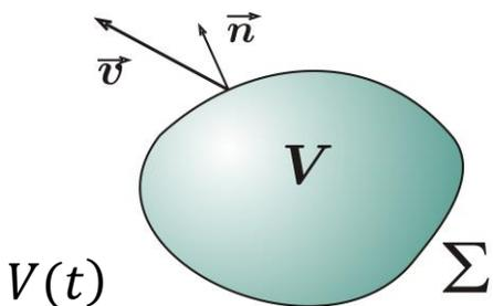
$V(t)$  - подвижный объем,  $\Sigma$  – его поверхность,  $\vec{n}$  - единичная нормаль к поверхности  $\Sigma$ , направленная во внешнюю сторону.
