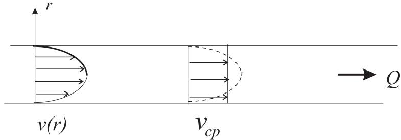
Из опыта известно, что при ламинарном режиме параболический профиль скорости устанавливается не сразу по выходе трубы из напорного бака, а на некотором расстоянии от него и таким остается вдоль всей остальной трубы. Поэтому для выполнения этой работы нужно, чтобы труба была достаточно длинная и измерения следует проводить достаточно далеко от начала трубы.
