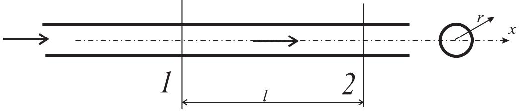
В ламинарном течении вектор скорости  $\mathbf{v}$  имеет только одну компоненту  $v_x = v$  вдоль оси трубы. На границе условие непроницаемости  $v_n = 0$  выполнено автоматически. Вследствие стационарности движения  $\partial v / \partial t = 0$ , и следовательно,  $v = v(x, r)$ ,  $p = p(x, r)$ . Система уравнений (1) принимает вид
