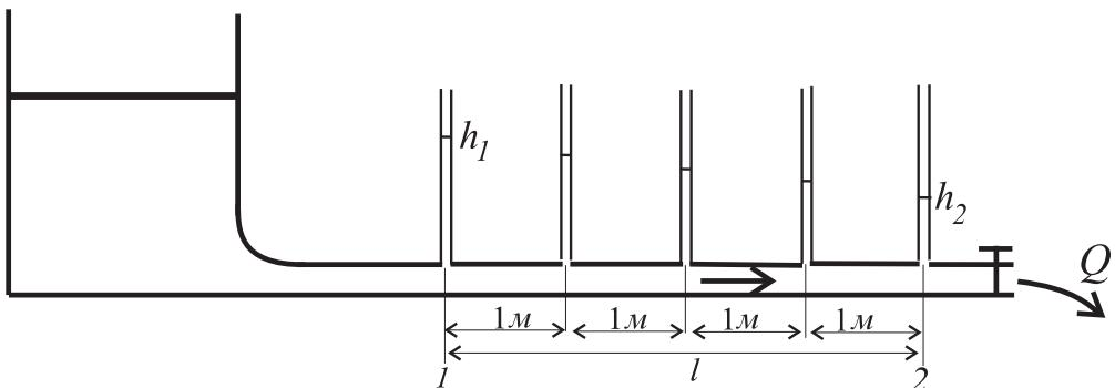
Расход воды через трубу регулируется вентильным краном на конце трубопровода. Расход  $Q$  измеряется с помощью мерного сосуда и секундометра как количество жидкости, вытекающее из трубы в единицу времени. Средняя скорость  $v_{cp} = Q/(\pi d^2/4)$ . Так как  $d$  и  $\nu$  постоянны, то  $\text{Re} \sim v_{cp}$ .
