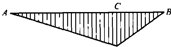
图 130. 在点 C 受载荷 P 的简支梁的弯矩图
