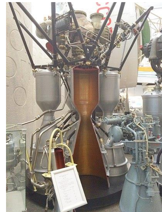
Поперечное сечение ракетного двигателя РД-107 (Государственный музей истории космонавтики имени К. Э. Циолковского)
