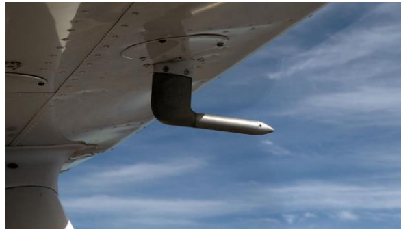
Трубка Пито-Прандтля на крыле самолета
